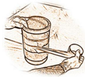
Para forrar pilares de hasta 4" de diámetro: Una vez pegado el lamistone® en su sitio envuélvalo con una cinta o film de plástico para que se mantenga fijo mientras seca la cola (24 horas).
