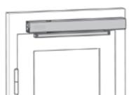
Montaje sobre marco con guía de deslizamiento
