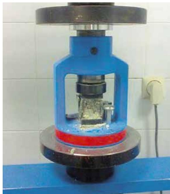
Ensayo de resistencia a compresión
