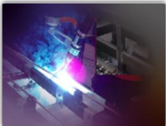
de soldar de aleación flexible. Esto le agrega mayor flexibilidad a los paneles sin sacrificar la resistencia del encofrado de aluminio cuando está en uso. Con esta flexibilidad se reducen y se eliminan rupturas de soldaduras.
