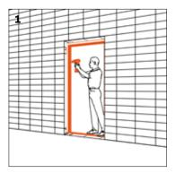
Fijación del nuevo marco al muro en fase de obra.
