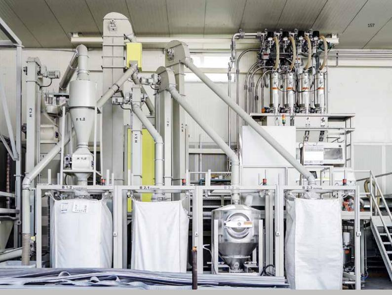
↑ La moderna planta de reciclaje permite reutilizar internamente los descartes y recortes de los perfiles de PVC.
