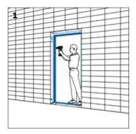
Fijación del premarco aislante térmico al muro en fase de obra.
