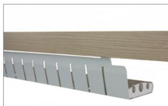
Canal metálica de chapa de 0,8 a 1 mm de espesor inferior de gran capacidad para mesas dobles de cableado y conexiones. Aporta una máxima accesibilidad, optimizando la superficie de trabajo, permitiendo una gestión del cableado óptima.
