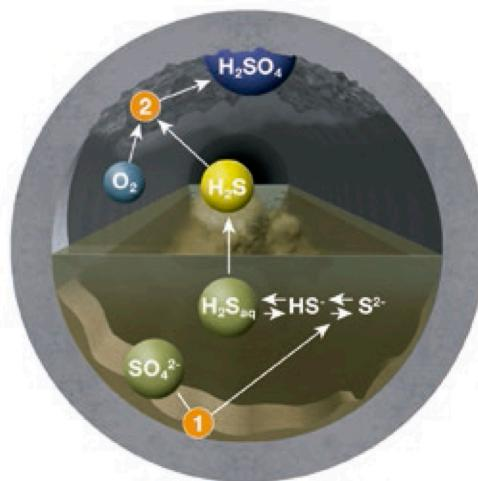
En esta ilustración se representan las diferentes reacciones que conlleva el proceso de corrosión por ácido sulfúrico biogénico.
