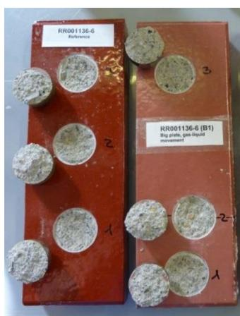
Fig. 2 Muestras después del ensayo de adherencia.
