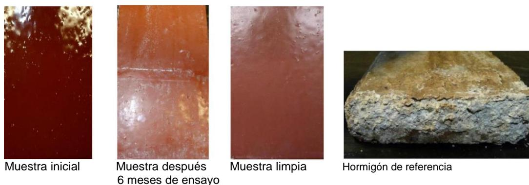
Fig. 1 Imágenes de las muestras de MasterSeal 7000CR después del ensayo.
