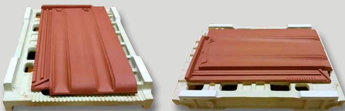
Soportes refractarios unitarios en H que permiten cocer las tejas de forma individual a alta temperatura, logrando una definición perfecta.
