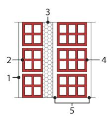
Ensayo realizado en el área de acústica del Laboratorio de Control de Calidad de la Edificación del Gobierno Vasco (informe B130-IN-CM-227), con la solución constructiva indicada, sin bandas perimetrales y con 42 mm de aislamiento.
