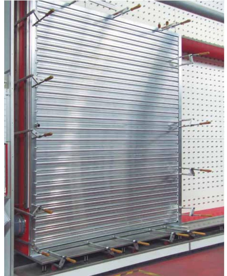
Ensayo de resistencia al viento de la lama **AC-150** en laboratorio de **Giménez Ganga**.
