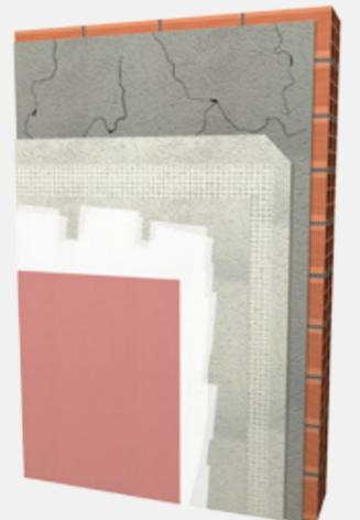
EJEMPLO DE SISTEMA SOBRE SOPORTE DE MONOCAPA RASPADO
