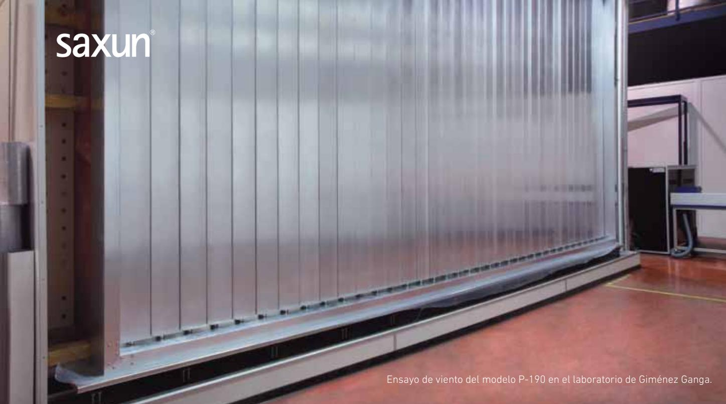
Ensayo de viento del modelo P-190 en el laboratorio de Giménez Ganga.
