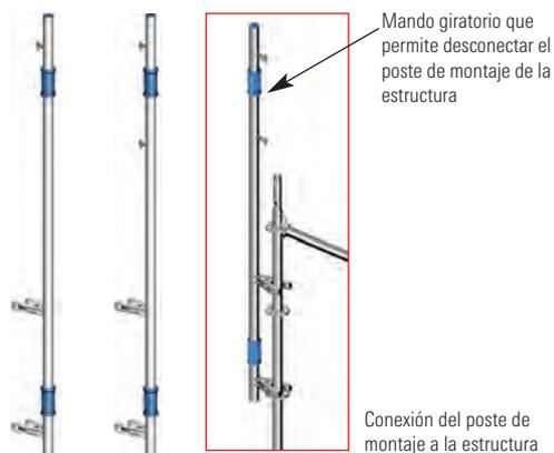
Mando giratorio que permite desconectar el poste de montaje de la estructura
