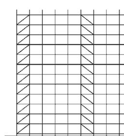
(Fig. 6) Diagonales en torre (el croquis no muestra anclajes a fachada).
