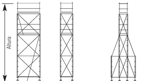
Escoger los rodillos según las cargas y la altura.
