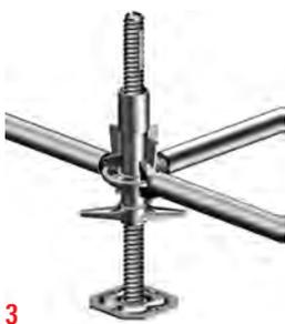
(3) Los collarines se conectan con las horizontales. Para formar ángulos rectos se usan las perforaciones pequeñas de la roseta.
