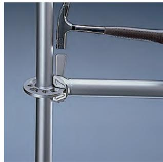
Un golpe con martillo en la cuña transforma la unión en una insuperable unión fija. La roseta sin cajeados ni rebordes evita la posible obstrucción con hormigón, espuma, suciedad, etc. que podría dificultar el montaje.
