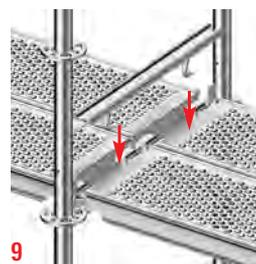
(9) Las plataformas estándar de acero, con ancho de 32 cm., terminan en garras que encajan en el perfil de las horizontales en U. El cierre de seguridad impide el levantamiento accidental de las mismas y colabora a la rigidez del conjunto.
