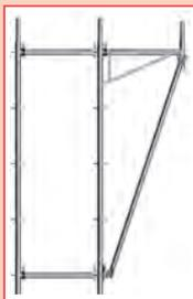
La ampliación de los andamios se consigue fácilmente gracias al uso de las ▶ **Ménsulas**, que se colocan en las rosetas del vertical. Para un uso estándar no se requieren realizar cálculos estáticos. Las plataformas colocadas en las ménsulas se tendrán que asegurar mediante la utilización de ▶ **Cierres de seguridad**, ref. 2634.
