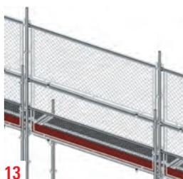
**(13)** En ocasiones puede ser necesario el montaje de un panel de rejilla para la protección de algún nivel en concreto, por ejemplo el nivel de alero de cubierta en una fachada.
